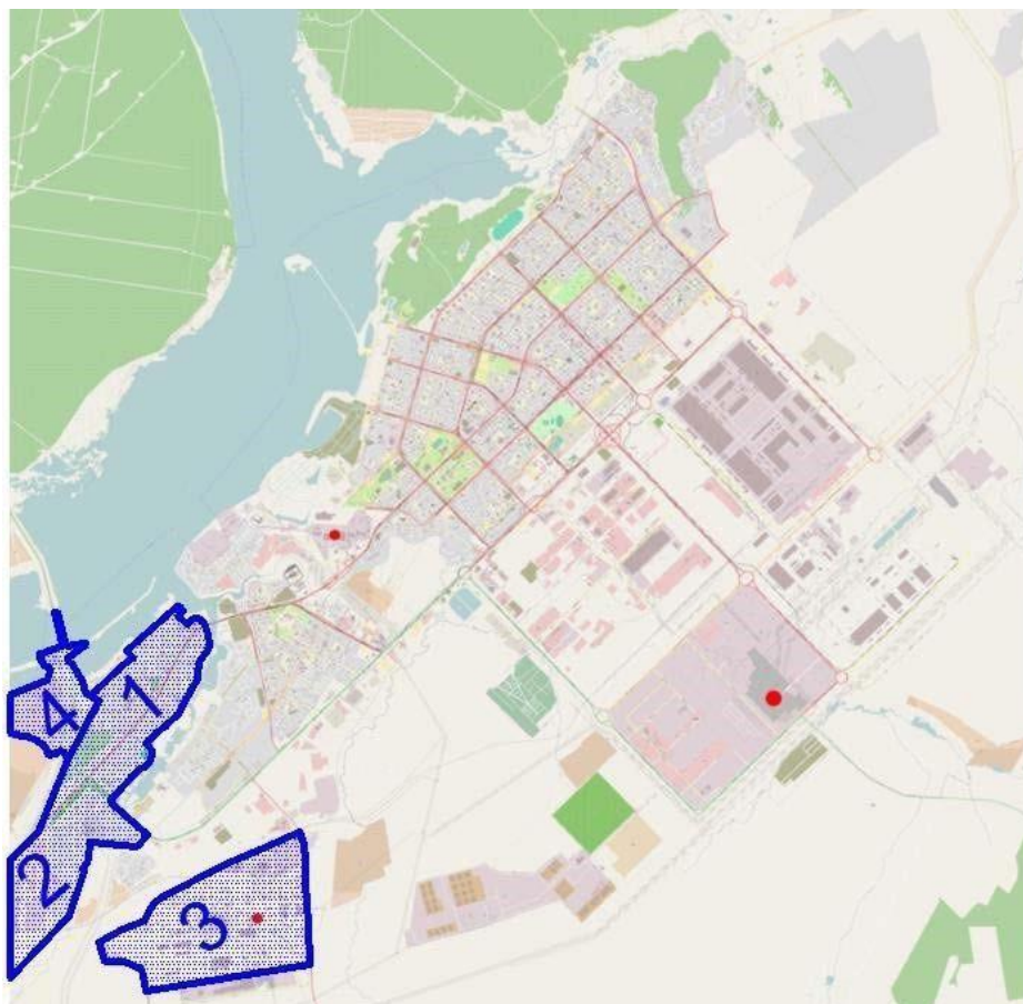
Рис. 2.14. Зоны действия источника тепловой энергии котельного цеха БСИ
