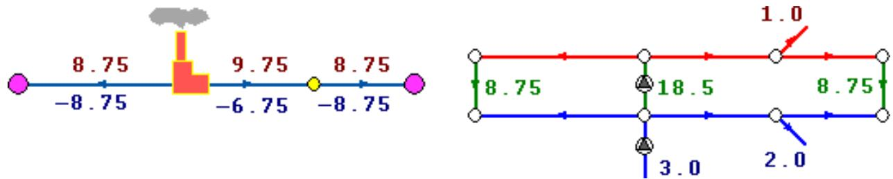
Если на одну сеть работает несколько источников, то в общем случае только на одном из источников с подпиткой можно одновременно поддерживать и давление в обратном трубопроводе и расположенный напор на выходе. У остальных источников с подпиткой можно поддерживать только давление в обратном трубопроводе.
