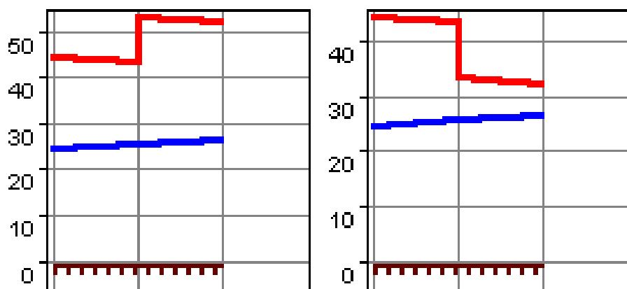
На рисунке видно, как различные направления участков, входящих и выходящих из насоса в сочетании с разными знаками напора на насосе влияют на результат расчета, отображенный на пьезометрических графиках.
