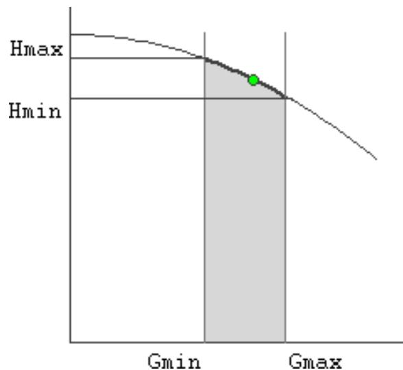
По заданным двум точкам определяется парабола с максимумом на оси давлений, по которой расчет и будет определять напор насоса в зависимости от расхода. Следует отметить, что характеристика, задаваемая таким образом может отличаться от реальной характеристики насоса, но в пределах рабочей области обе характеристики практически совпадают.
