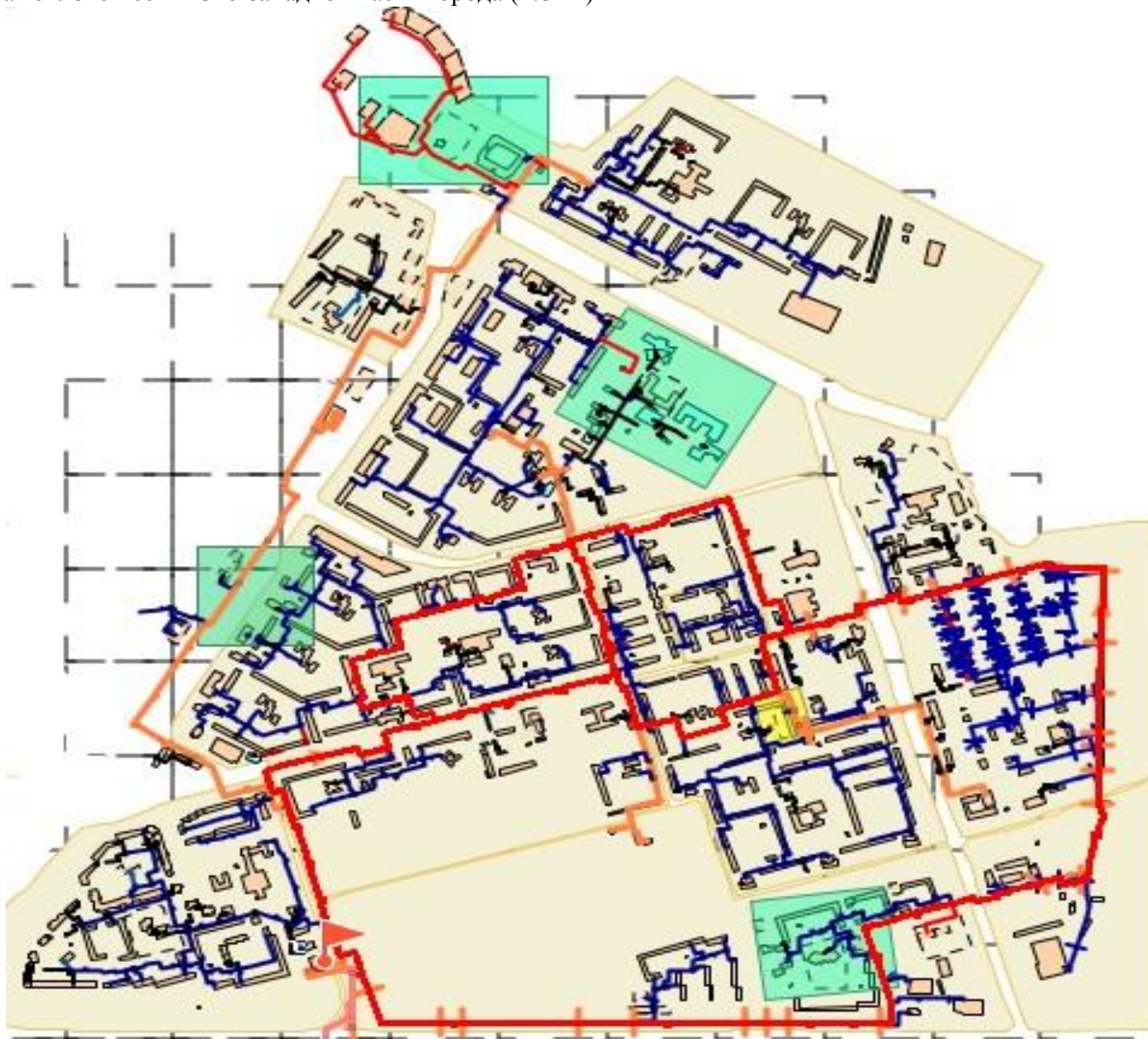
Рис. 4.5. Схема тепловой сети Юго-западной части города (п.ЗЯБ)
