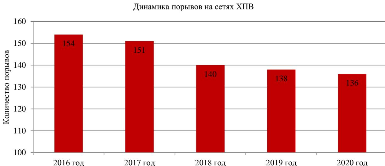
Снижение потерь воды при транспортировке и количества аварий связано с плановым проведением капитального ремонта водопроводных сетей с истёкшим сроком службы.
